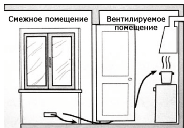
Рис. 3. Устройство вентиляции через смежное помещение
